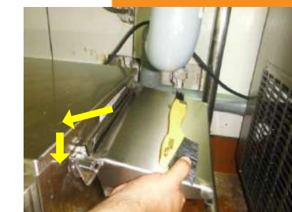
15 COLOCAR SOPORTE DEL CONTENEDOR DE GRASA
